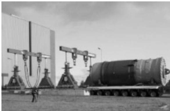
図4 RPVの大型トレーラによる原子炉建屋からISNへの移送
